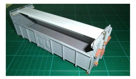
Das Gehäuse wird umwikkelt mit Haushaltfolie und an die Bodenseite festgeklebt.
