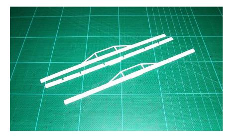
Auf die Beine werden Stützpunkten geklebt für die Halterung von dem Bremsklotzen.
