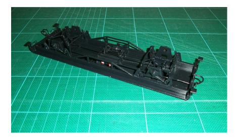
Schließlich werden die Federpuffer und Schraubenkupplungen montiert. Auch die Radsätze werden zum Probelauf montiert.
