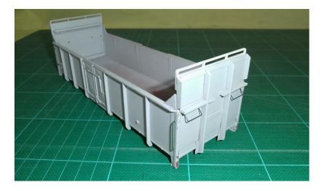
Auch die Stirnleitern und die geätzte Treppe werden auf das Gehäuse geklebt.
