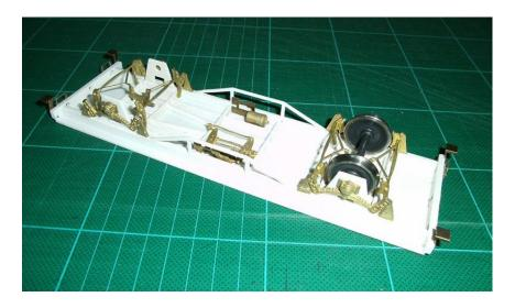
Weiter mit der Bremsstange und mit Bremsschlauche vervollständigt.
