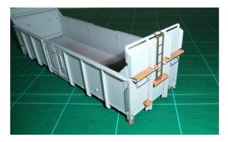
An die Unterseite werden Löcher gebohrt und mit Splinte bestückt.
