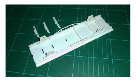
Die diagonal gesetzten Profilträger werden in die richtige Stelle geschoben und fixiert. Auch die weiteren Hilfsträger werden montiert.
