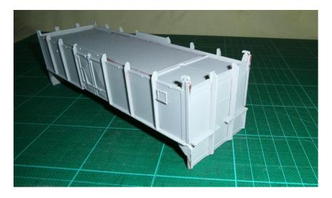
Auf das Gehäuse werden an die Stirnseiten die Schütz Bügel für die plane geklebt.
