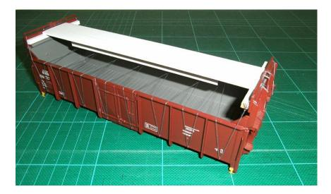
Die Plane wird jetzt auf das Gehäuse festgeklebt.
