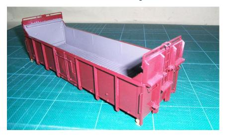
Das Gehäuse wird mit beschriftet in Abreibe-Technik, (NMBS Version, Epoche 4) und wird mit Klarlack überzogen.
