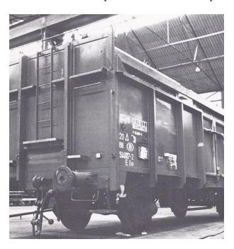
Diese Hochbordwagen sind weiter umgebaut worden mit erhöhte Stirnwände und Stützbügel für eine Plane. Die Wagen sind ausgerüstet mit ein verstellbares Rahmenwerk um die Glasplatten zu verriegeln beim Transport, erreichbar mit Leitern und Trittstufen auf die Stirnseiten.
